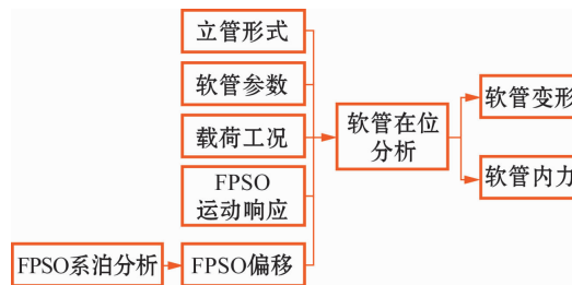
图 2 柔性立管整体分析图解
