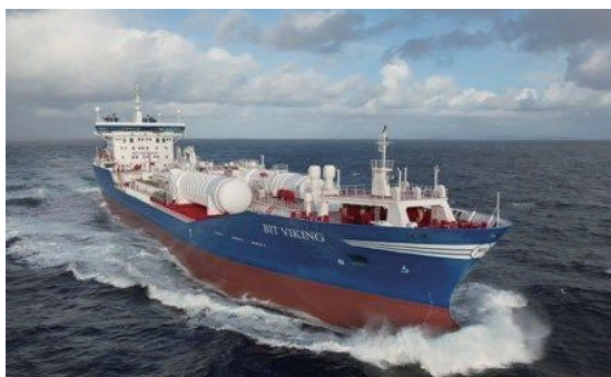
图3 世界首艘改装 LNG 燃料动力成品油轮, LNG 燃料容量 2 \times 500 \text{ m}^3 Fig. 3 The first modified LNG fueled ship. Its LNG fuel capacity is 2 \times 500 \text{ m}^3
