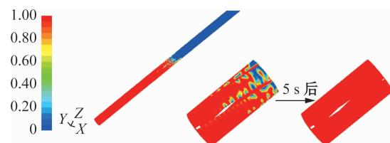
图 9  $30^{\circ}$ 井斜角  $30^{\circ}$ 螺旋角旋流扶正器顶替界面分布云图
