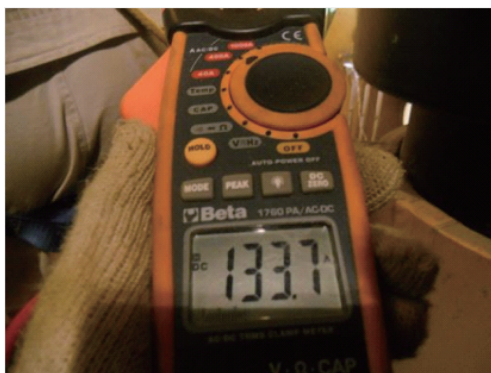
图4 监控焊接电流
