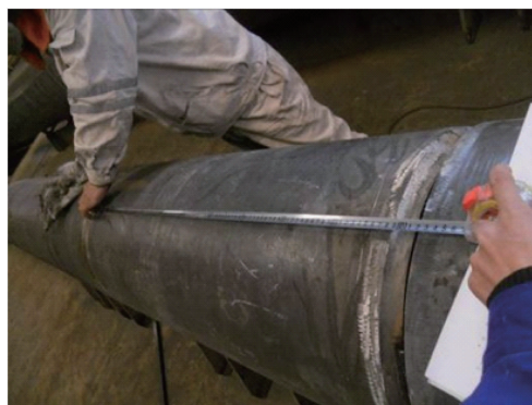
图1 卷管长度测量
