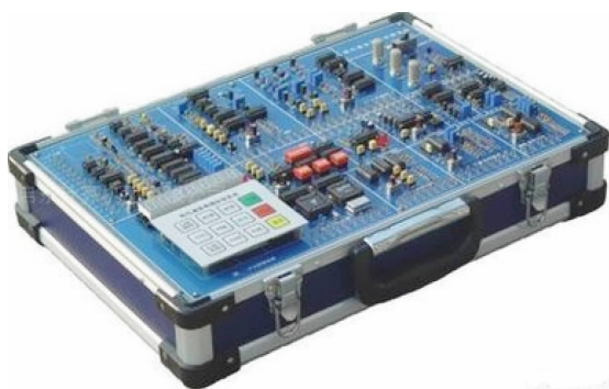
图 6 在通信原理实验箱上进行单边带调幅实物实验
