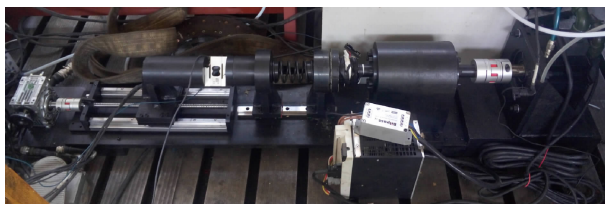
图11 干式离合器摩擦片摩擦系数测试台架
